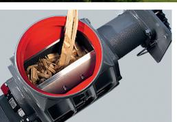
Patentierter Einkammer-Zellradschleuse für höchste Sicherheit gegen Rückbrand
